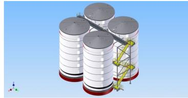
Diseño de 4 tanques de acero inoxidable para almacenamiento de jarabe. El diseño además incluye la plataforma y escalera de acceso a las tapas de los tanques para realizar tareas de mantenimiento e inspección. El uso del cálculo por elementos finitos del cuerpo del tanque permitió la optimización del espesor de la chapa que se usó en la construcción del tanque.
